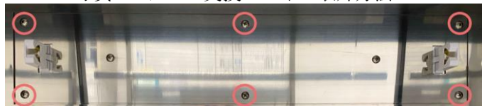
写真 2<グロー交換 パネル取外方法>
